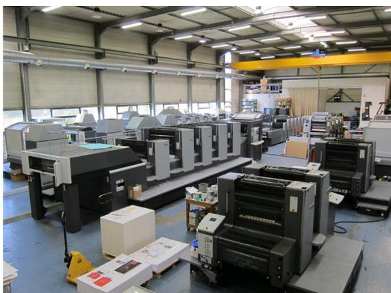
INTERGRAPHIC est une entreprise, créée en 1991, spécialisée dans l'achat, la rénovation et la revente de presses offset, principalement de la marque Heidelberg. Toutes les machines sont entièrement démontées et nettoyées par projection de granules de glace sèche à - 80° qui n'altère pas le surfaçage des différents éléments; ces éléments sont ensuite repeints et remontés.
